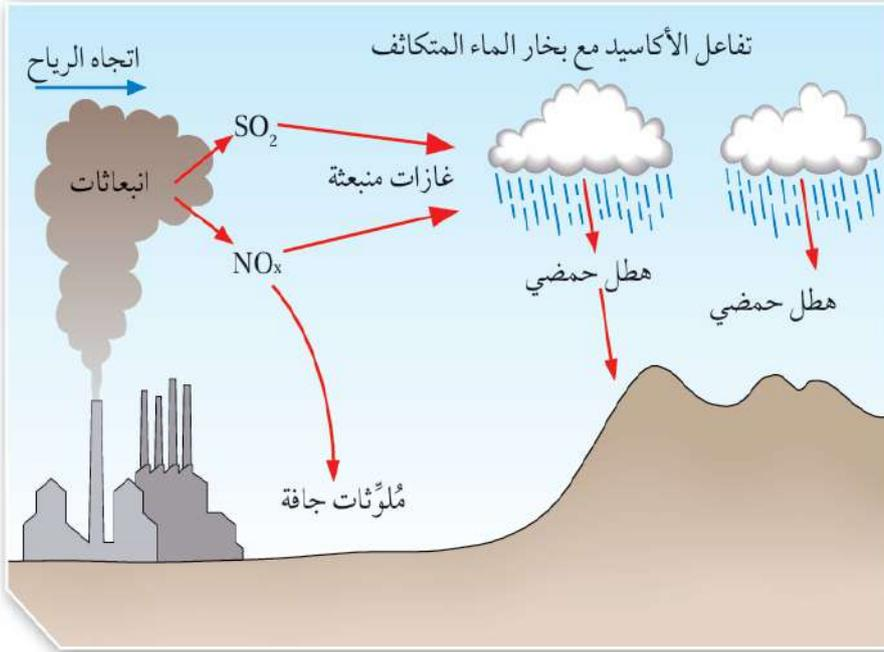
الشكل (8): رسم توضيحي لعملية تكوّن الهطل الحمضي.
