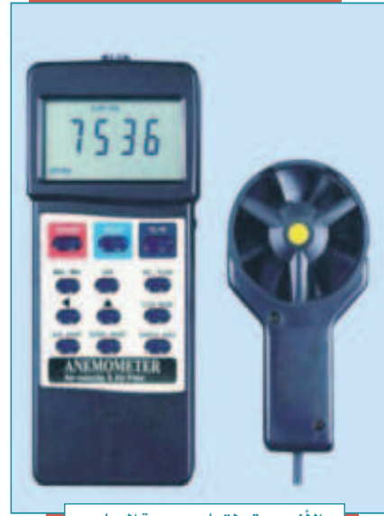
الأنيمومتر لقياس سرعة الرياح
