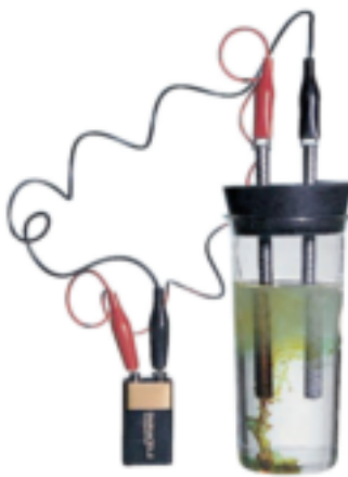
شكل (٢-١٣): خلية تحليل محلول يوديد البوتاسيوم.
