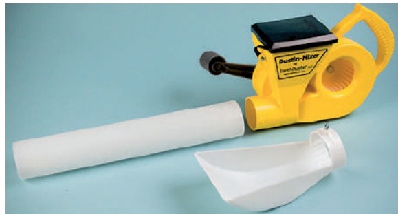
آلة تعفير يدوية تستعمل لنثر المبيدات ، وقبل التطور التكنولوجي كان المزارع يستعمل قطعة من القماش للتعفير
