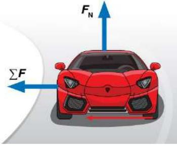
بسبب القوة المركزية التي تمنع حصول ذلك وهي قوة جانبية منشؤها قوة الاحتكاك السكوني بين إطارات السيارة وسطح الطريق تؤثر نحو مركز الدائرة التي يعد المنعطف جزءاً منها.
