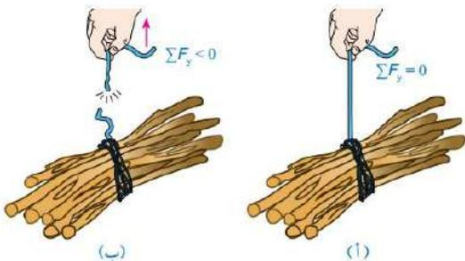
لأن لكل حبل أو سلك قوة شد عظمى يتحملها قبل أن ينقطع ، وبالتالي مع زيادة سرعة الرفع يزداد التسارع وهذا يعني أننا نحتاج قوة شد أكبر من قدرة تحمل الحبل.
