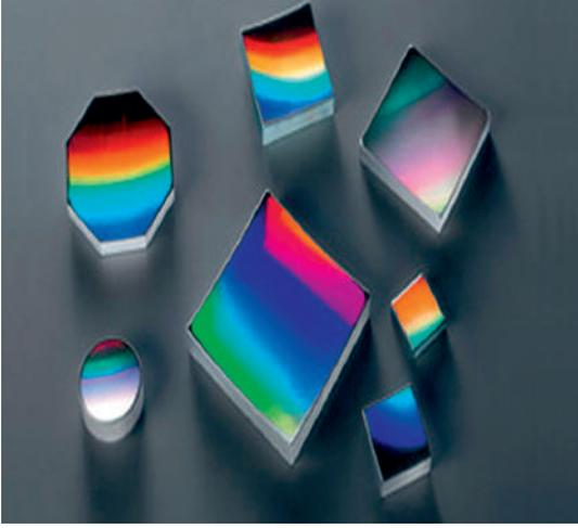
على الرغم من أن تداخل الشق المزدوج وحيود الشق المفرد يعتمدان على الطول الموجي للضوء؛ فإن محرزوات الحيود الموضحة في الشكل 11-6 تُستخدم لجعل قياسات الطول الموجي أكثر دقة. ومحرزوات الحيود عبارة عن أداة مكوّنة من شقوق عدة مفردة مستقيمة ومتوازية، تسبب حيود الضوء، وتكوّن نمط حيود ناتجاً عن تداخل أنماط حيود الشق الأحادي. ويمكن أن يتكوّن محزور الحيود من 10000 شق لكل سنتيمتر. لذا فإن المسافة بين الشقوق يمكن أن تكون صغيرة جداً تصل إلى  $10^{-6}$  m أو 1000 nm.
