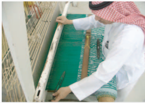
الشكل (٦): نلاحظ كيف يمرر النساخ المكوك .
