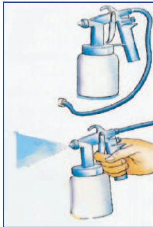
الشكل (١١): بخاخة موصلة بمضخة.
