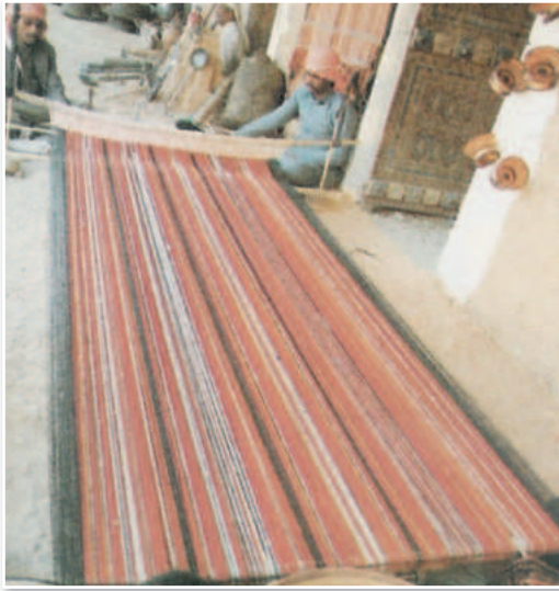
الشكل (٩): نول أرضي لإنتاج قطعة كبيرة.
