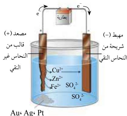
الشكل (18): تنقية النحاس بالتحليل الكهربائي.
