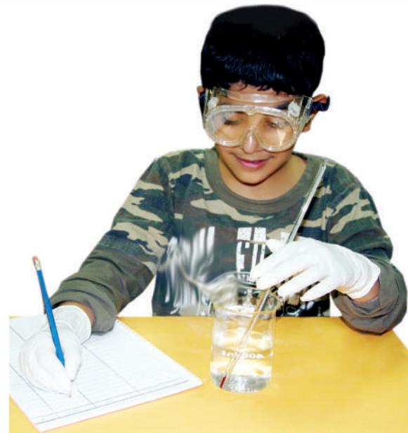
الشكل ١٤ يستعمل مقياس درجة الحرارة لقياس درجة حرارة الأجسام. ومعظم مقاييس درجة الحرارة في المختبرات هي عبارة عن أنبوب زجاجي في نهايته مستودع، يحتوي على سائل مثل الكحول الملون. ويرتفع السائل في الأنوب أو ينخفض كلما تغيرت درجة الحرارة، ولقراءة درجة الحرارة حرك المقياس بشكل دائري حتى تتمكن من مشاهدة السائل الملون، واقرأ درجة الحرارة عند نهاية السائل.
