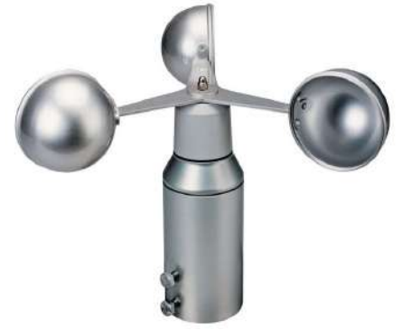
الشكل ٦ يستخدم جهاز الأنيمومتر في قياس سرعة الرياح، حيث تزداد سرعة دوران الأكواب بزيادة سرعة الرياح.
