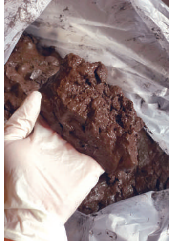
الشكل (12): الحمأة التي تترسب في أثناء معالجة المياه العادمة.
