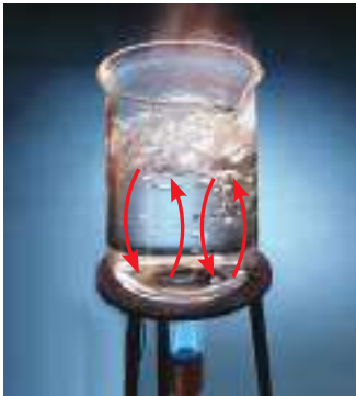
انتقال الحرارة بتيارات الحمل
