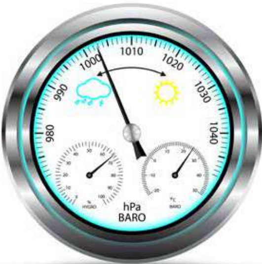
الشكل (20): بارومتر فلزي، يقيس الضغط الجوي بوحدة الهكتوباسكال (hPa).
