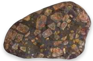
الشكل (8): النسيج السماقي الذي يمتاز بوجود بلورات كبيرة الحجم محاطة ببلورات صغيرة الحجم.
