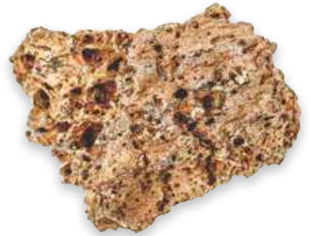
الشكل (9): النسيج الفقاعي الذي يمتاز بوجود ثقوب في الصخر الناري نتيجة خروج الغازات.
