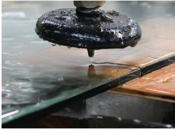
آلة قص للحجر بتقنية نفث الماء water jet
