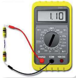
الشكل (٤) قياس المقاومة بجهاز المالتيميتر
