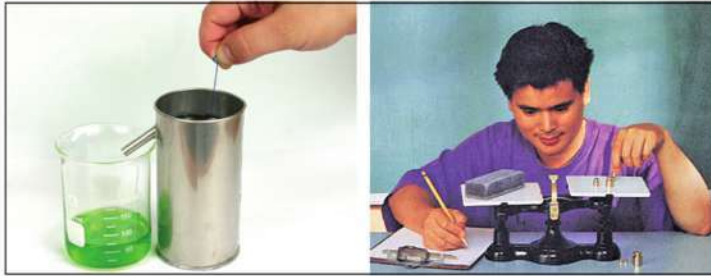
شكل (١٠): قياس الكثافة باستخدام الميزان والمخبر المدرج ينتج عنه خطأين في القياس.
