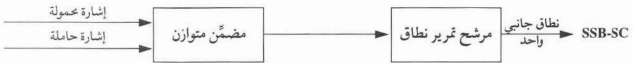
الشكل (١-٦): مخطط صندوقي لمضمّن الاتساع ذي النطاق الجانبي والحاملة المحذوفة
