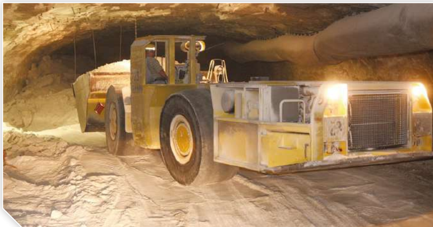
الشكل (16): حفارة تحت سطح الأرض في نفق مائل داخل منجم لاستخراج الملح الصخري.
