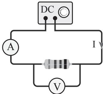
1. أصل الدارة الكهربائية كما في الشكل، بحيث يتصل طرفا المقاومة مع طرفي مصدر فرق الجهد، ويقاس الأميتر (A) التيار المار في المقاومة، بينما يقيس الفولتميتر (V) فرق الجهد بين طرفيها.
