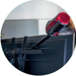
■ استخدامُ منفاخِ الهواءِ لتنظيفِ جهازِ الحاسوبِ من الغبارِ باستمرارٍ، معَ التركيزِ على تنظيفِ الشاشةِ بالمرورِ على الفُتحاتِ جميعها الموجودةِ في جوانبِ الشاشةِ من الأعلى إلى الأسفلِ، وتنظيفِ الطابعاتِ والسماعاتِ من الخارجِ، بالإضافةِ إلى تنظيفِ وحدةِ النظامِ حيثُ يُمرَّرُ منفاخُ الهواءِ على فُتحاتِ التهويةِ جميعها وحوالَ مراوحِ التبريدِ ومشغلاتِ الأقراصِ، وتنظيفِ الأسلاكِ المكشوفةِ.
