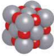
الشكل (24): بلورة أكسيد الكالسيوم.
