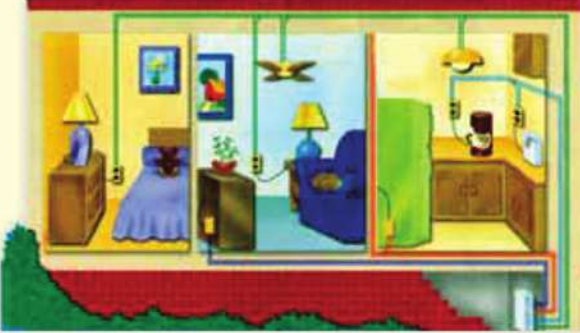
شكل (٢-١٤): طريقة توصيل المصابيح الكهربائية فى المنزل.
