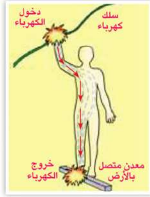
شكل (٢-٢): مرور التيار الكهربى فى جسم الإنسان يؤدى إلى حدوث صدمة كهربية.
