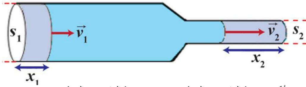
بفرض أن  $v_1$  سرعة المائع عبر المقطع  $s_1$ ، و  $v_2$  سرعة المائع عبر المقطع  $s_2$  إن حجم كمية السائل التي تعبر المقطع  $s_1$  لمسافة  $x_1$  خلال الزمن  $\Delta t$  يكون:
