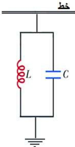
تستخدم الدارة الخائفة في وصل خطوط نقل الطاقة الكهربائية مع الأرض بهدف ترشيح التواترات التي يلتقطها الخط من الجو وذلك بجعل تواتر تجاوب الدارة المهتزة مساوياً لتواتر تيار خط النقل فتكون ممانعتها لا نهاية بالنسبة لهذا التواتر بينما تمر بقية التواترات الملتقطة من الجو عبر الدارة المهتزة إلى الأرض
