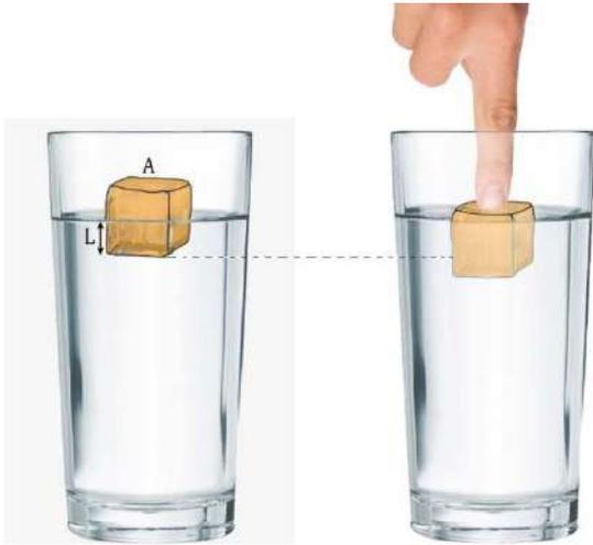
ليكن لدينا كأس يحوي ماء كثافته الحجمية  $\rho_{H_2O}$  ، نضع فيه مكعب خشبي كثافته  $m_{wood}$  وكثافته الحجمية  $\rho_{wood}$  حيث  $\rho_{wood} < \rho_{H_2O}$  ومساحة سطحه A فيطفو وهو بحالة توازن وقد برز جزء منه فوق سطح الماء. نؤثر بقوة شاقولية على المكعب ليغمر كلياً بالماء ثم نتركه فجأة. استنتج طبيعة حركة المكعب الخشبي.
