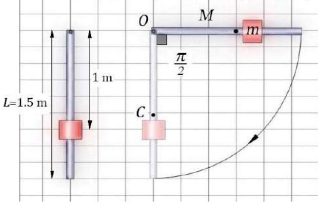
يتألف نواس ثقلي مرگب من ساق شاقولية، متجانسة، كتلتها  $M = 0.5 \text{ kg}$  ، طولها  $1.5 \text{ m}$  ، يمكنها أن تنوس حول محور أفقي مار من طرفها العلوي، ومثبت عليها كتلة نقطية  $m' = 0.5 \text{ kg}$  على بُعد  $1 \text{ m}$  من هذا الطرف، كما في الشكل المجاور. **المطلوب:**
