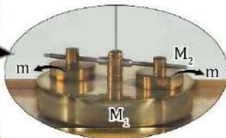
تتألف ميقاتيه من قرص نحاسي كتلته  $M_1 = 0.12 \text{ kg}$  ، نصف قطره  $R = 0.05 \text{ m}$  مثبت عليه ساق كتلتها  $M_2 = 0.012 \text{ kg}$  ، طولها  $L = 0.1 \text{ m}$  تحمل في طرفيها كتلتين نعدّهما نقطيتين  $m_1 = m_2 = 0.05 \text{ kg}$  ، كتلتين تبعدان عن بعضهما مسافة قدرها  $2r = 0.04 \text{ m}$  يمكن تغييرها بواسطة بزال، نعلق جملة القرص وما عليه من مركز عطالتها إلى سلك فتل شاقولي ثابت فتله  $k = 8 \times 10^{-4} \text{ m.N.rad}^{-1}$  . **المطلوب:**
