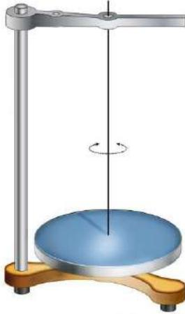
يتألف نواس فتل من قرص متجانس كتلته  $m = 2 \text{ kg}$  ، نصف قطره  $r = 4 \text{ cm}$  ، معلق من مركزه إلى سلك فتل شاقولي ثابت فتله  $k = 16 \times 10^{-3} \text{ m.N.rad}^{-1}$  ، ندير القرص في مستوٍ أفقي زاوية  $\theta = +\frac{\pi}{4} \text{ rad}$  عن وضع توازنه، ونتركه دون سرعة ابتدائية في اللحظة  $t = 0$  . **المطلوب:**
