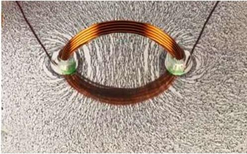
في إحدى التجارب مرّر تياراً كهربائياً متواصلًا شدته 10 A في ملف دائري نصف قطره 10 cm، وقيست شدّة الحقل المغناطيسي بواسطة مقياس تسلا في مركز الملف، وكوّرت التجربة السابقة من أجل ملفات متماثلة في نصف قطرها الوسطي ومختلفة في عدد لفاتها، وكانت النتائج وفق الجدول الآتي:
