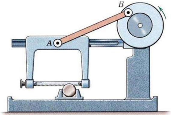
يوضح الشكل المجاور منشار لقطع المعادن يعمل بشكل آلي من خلال وصله بمحرك كهربائي يدور بسرعة زاوية ثابتة.
