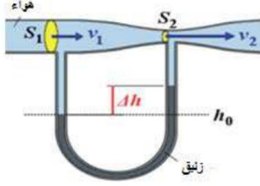
مسألة : تستخدم أنبوبة بيتوت لقياس سرعة الهواء فإذا كان السائل المستخدم في الأنبوبة هو الزئبق وكثافته  $13600 \text{ kg/m}^3$ ، وكانت  $h = 5 \text{ cm}$ ، فاحسب سرعة الهواء علماً بأن كثافة الهواء هي  $1.29 \text{ kg/m}^3$ .
