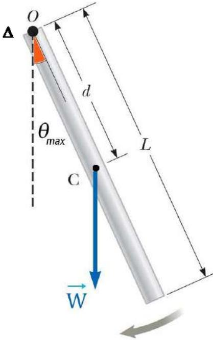
نواس ثقلي مؤلف من ساق متجانسة طولها  $L = 0.375 \text{ m}$  وكتلتها  $M$  معلقة من طرفها العلوي بمحور أفقي عمودي على مستويها الشاقولي، نزيح الساق عن موضع توازنها الشاقولي زاوية صغيرة  $(\theta \leq 14^\circ)$  ونتركها دون سرعة ابتدائية استنتج بالرموز العلاقة المحددة للدور الخاص انطلاقاً من العلاقة العامة للدور الخاص للنواس الثقلي المركب ثم احسب قيمتها، علماً أنّ عزم عطالة الساق حول محور عمودي على مستويها ومار من مركز عطالتها  $(I_{\Delta/C} = \frac{1}{12} M L^2)$
