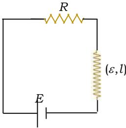
نربط وشيعية ذاتيتها  $L$ ، على التسلسل مع مقاومة أومية  $R$ ، ومولّد قوته المحركة الكهربائية  $E$  كما في الدارة الموضحة بالشكل:
