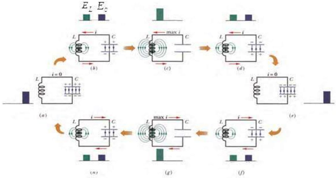
تبدأ المكثفة بتفريغ شحنتها في الوشيعه فيزداد تيار الوشيعه ببطء حتى يصل إلى قيمة عظمى نهاية ربع الدور الأول من التفريغ عندما تفقد المكثفة كامل شحنتها فتخزن الوشيعه طاقة كهربية
