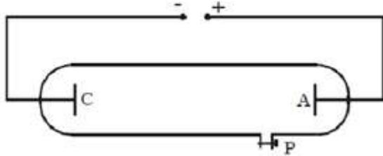
(anode) كما هو موضح في الشكل. في أحد الجانبين توجد فتحة توصل إلى مخلية ضغط p بواسطتها يمكن التحكم بالضغط داخل الأنبوب. يتم توصيل طرفي الأنبوب أي القطبين إلى دارة تيار AC عالي التوتر من مرتبة 50 kv.
