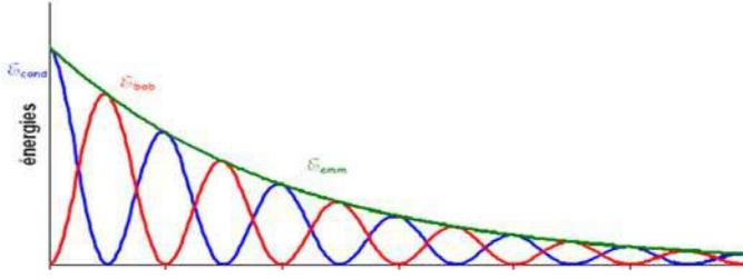
• عندما تكون مقاومة الوشيعة صغيرة فإنّ الطاقة تتبدّد تدريجياً على شكل طاقة حرارية بفعل جول مما يؤدي إلى تخامد الاهتزاز.
