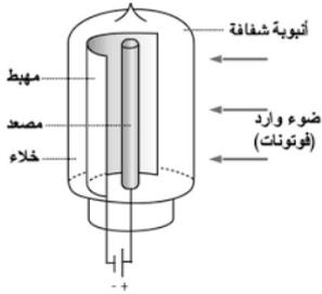
تتألف الخلية الكهروضوئية من حبابة زجاجية من الكوارتز مخلّاة من الهواء، تحتوي مسرى معدني يغطي سطحه طبقة رقيقة من معدن قلوي تتلقّى الضوء، يسمى المهبط C، كما تحتوي على مسرى آخر يسمى المصعد A.
