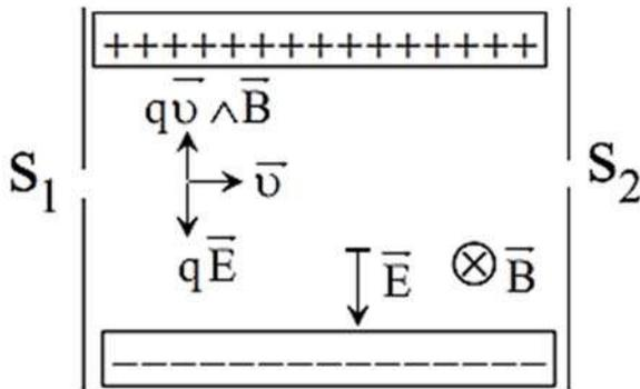
تتأثر الجسيمات المشحونة بالحقلين الكهربائي والمغناطيسي بحيث تكون القوة الكهربائية للأسفل واتجاه القوة المغناطيسية للأعلى وهذا يؤدي إلى أنّ الجسيمات سوف تنحرف عن المسار المستقيم لكن بعض الجسيمات التي لها سرعة معينة ستكون شدة القوة الكهربائية  $F$  تساوي شدة القوة المغناطيسية  $F'$  فتبقى هذه الجسيمات على مسار مستقيم يسمح لها ذلك الخروج من الشق  $S_2$ .
