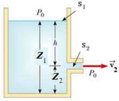
يحتوي خزان على سائل (مائع) كتلته الحجمية  $\rho$ ، سطح مقطعه  $s_1$  كبير بالنسبة إلى فتحة جانبية مساحة مقطعها  $s_2$  صغيرة تقع قرب قعره وعلى عمق  $z_2 - z_1 = h$  عن السطح الحرّ للسائل. ما السرعة التي يخرج بها السائل من الفتحة الجانبية؟
