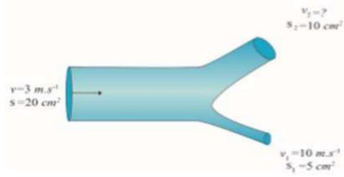
4- بيّن الشكل المجاور دخول سائل مثالي عبر المقطع  $s_1$  بسرعة  $v_1$  ليتفرّع إلى فرعين مساحة مقطع الفرع الأول  $s_2$  ، وسرعة جريان السائل عبره  $v_2$  ، ومساحة مقطع الفرع الثاني  $s_3$  ، فتكون سرعة جريان السائل عبر مقطع الفرع الثاني  $v_3$  مساوية:
