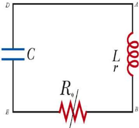
نشكّل دارة كهربائية تحتوي على التسلسل وشية  $(L, r)$ ، ومكثفة مشحونة سعتها  $C$ ، ومقاومة  $R_0$  كما في الشكل، اكتب عبارة التوتر بين طرفي كل جزء في الدارة، ثم استنتج المعادلة التي تصف اهتزاز الشحنة فيها؟
