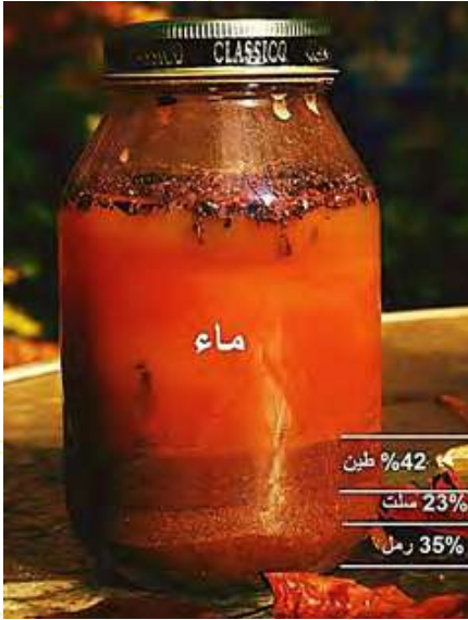
عينة مخبرية من تربة أرض سعيد بعد خلطها بالماء
