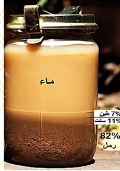
عينة مخبرية من تربة أرض نبيل بعد خلطها بالماء
