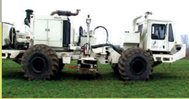
الصورة رقم (1) تبين الآلية المستخدمة في توليد الموجات
