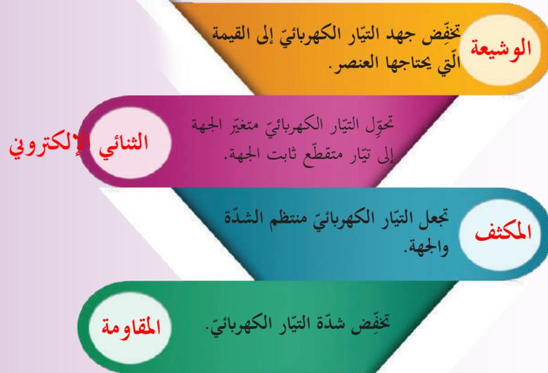
هذه القطع تعمل معاً لإنتاج الجهد الكهربائي.
