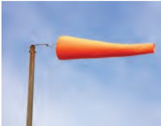
الشكل 6 يوضح قمع الرياح اتجاهها. بينما يقيس المريح سرعتها. يشير قمع الرياح إلى الجنوب مما يعني أن الرياح قادمة من الشمال.
