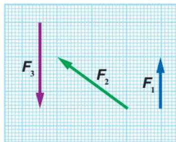
نقيس بالمسطرة طول سهم المحصلة ( $R$ ) في الشكل وحسب مقدار مقياس الرسم نستطيع معرفة مقدار المحصلة ، وفي شكلنا ومثالنا من الكتاب تبين معنا بأن طول السهم (4.1 cm) وبحسب مقياس الرسم (1 cm : 10 N) فإن مقدار المحصلة يساوي (41 N) ونقيس بالمنقلة الزاوية بين متجه المحصلة ( $R$ ) ومحور (+x) ← ( $194^\circ$ ) لتمثل اتجاه المحصلة.
