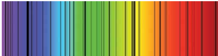
الشكل ٨-٩ طيف امتصاص خطي تشكّل عند مرور الضوء الأبيض عبر بخار الزئبق البارد.
