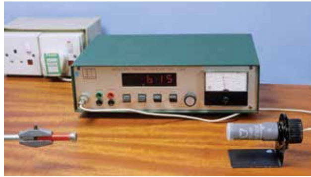
الصورة ٩-٢ يمكن أن يضبط الثابت الزمني لمقياس معدّل العد هذا لتخفيف التذبذبات السريعة في معدّل العدّ.
