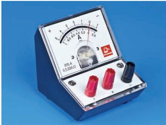
الأميتر يقيس شدة التيار الكهربائي.
