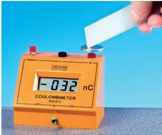
إيجاد نوع الشحنة الكهربائيّة باستخدام جهاز قياس الشحنة الكهربائيّة
