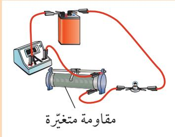
سيوضح لك معلمك كيف يتم استخدام المقاومة المتغيرة لتغيير التيار في الدائرة الكهربائية.
