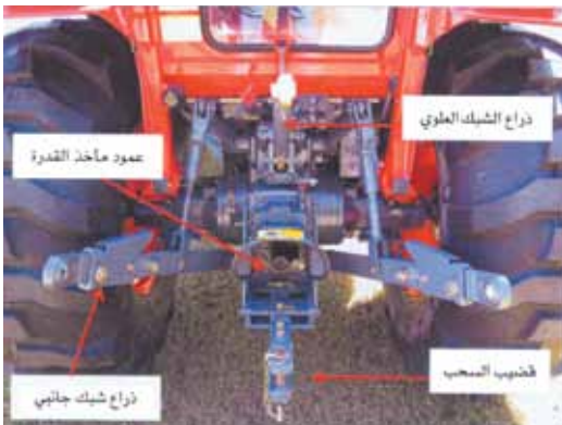
الشكل (٦): الأجزاء الخاصة بنقل وتشغيل الآلات الزراعية.
