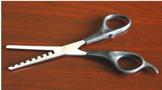
الشكل (٢-٦): مقصّ التخفيف ذو الأسنان المتباعدة من جهة واحدة.
