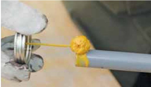
الشكل (١٠-٢): التوصيلُ بوساطةِ لاصقٍ خاصٍّ.
