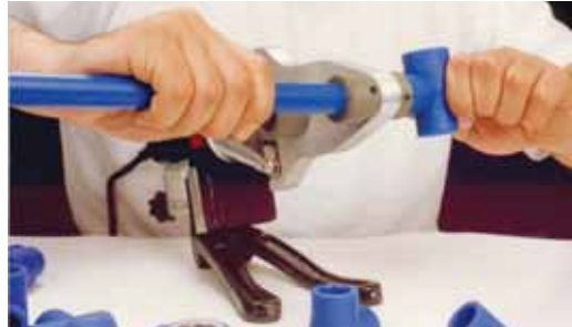
الشكل (٩-٢): التوصيلُ بوساطةِ ماكينةِ لحامِ أنابيبِ البلاستيكِ.
