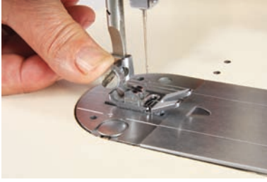
الشكل (١٠-٢٠) إنزال رافعة القدم الضاغطة لتثبيتها.
