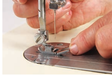
الشكل (١٠-١٩): إعادة تركيب القدم الضاغطة متعددة الأغراض.
