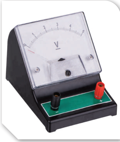
الشكل (9): الفولتميتر جهاز يستخدم لقياس فرق الجهد.
