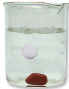
الشكل (6): حجر مغمور كلياً في الماء، بينما تبقى الكرة معلقة داخل الماء.
