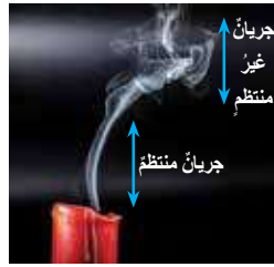
الشكل (18): الجريان المنتظم والجريان غير المنتظم لجزيئات الدخان المنبعثة عند إطفاء الشمعة.
