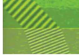
الشكل (17): انكسار موجات سطح الماء المستوية.
