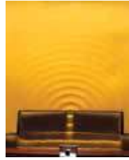
الشكل (22): حيود موجات سطح الماء عند نفاذها من فتحة واسعة وأخرى ضيقة.
