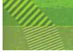
الشكل (17): انكسار موجات سطح الماء المستوية.
