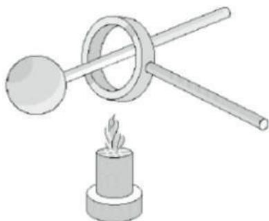
2 - عند تسخين الكرة الموضحة في الشكل المجاور، يصعب إدخالها عبر الحلقة، بسبب تمددها وزيادة حجمها. ماذا لو سخنا الحلقة بدلًا من تسخين الكرة، هل يمكن إدخال الكرة عبر الحلقة؟ أفسر إجابتي.
