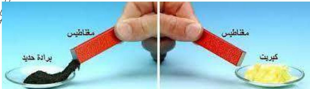
● يُستخدم المغناطيس العملاق لفصل الحديد و الفولاذ عن المواد الأخرى لإعادة تدويرها
