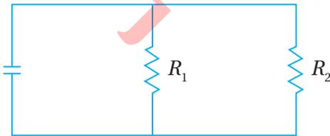
19 **كهرباء:** تعطى المقاومة المكافئة  $R$  بالأوم ( $\Omega$ ) للمقاومتين  $R_1$  و  $R_2$  الموصولتين على التوازي، كما في الشكل المجاور، بالعلاقة الآتية:
