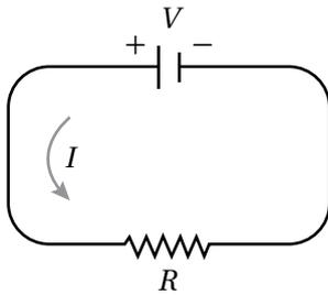
4 تُمثّل المعادلة:  $V = IR$  جهد الدارة الكهربائيّة (بالفولت) المُبيّنة في الشكل المجاور، حيث  $I$  شدّة التيار بالأمبير، و  $R$  المقاومة بالأوم. إذا كان جهد الدارة يزداد بمعدل  $1 \text{ volt/s}$ ، وشدّة التيار تقل بمعدل  $\frac{1}{3} \text{ amp/s}$ ، فأجد معدل تغير  $R$  عندما  $V = 12$ ،  $I = 2$ .
