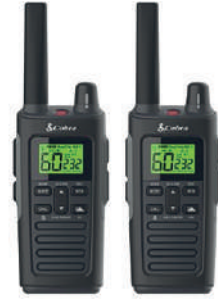
الشكل (37): أجهزة الاتصال اللاسلكي، كلّ جهاز يحتوي دائرة إرسال ودائرة استقبال.
