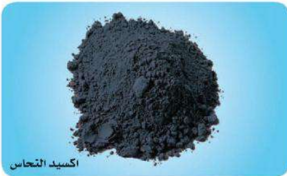
▲ شكل (٤) ينحل هيدروكسيد النحاس (أزرق اللون) بالحرارة إلى أكسيد النحاس (أسود اللون)
