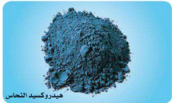
▲ شكل (٤) ينحل هيدروكسيد النحاس (أزرق اللون) بالحرارة إلى أكسيد النحاس (أسود اللون)
