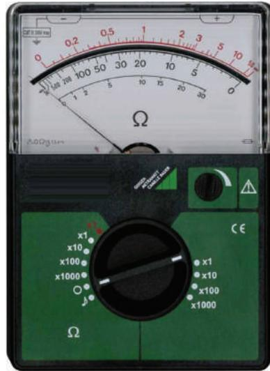
الشكل (11): جهاز قياس المقاومة ذو مؤشر (تمائلي).
