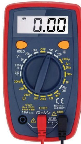
الشكل (2): جهاز قياس رقمي متعدّد الأغراض.
