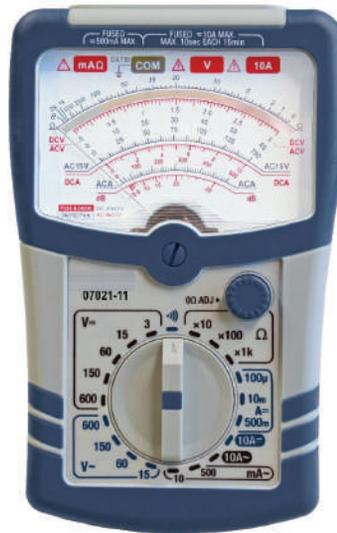
الشكل (1): لوحة بيان جهاز قياس تماثلي متعدّد الأغراض.
