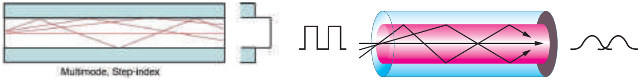
الشكل (30): الليف المُتعدّد الأنماط بمعامل انكسار خطوي.
