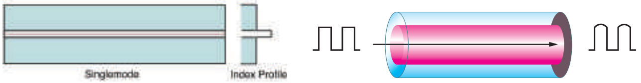
الشكل (29): الليف الأحادي النمط بمعامل انكسار خطوي.
