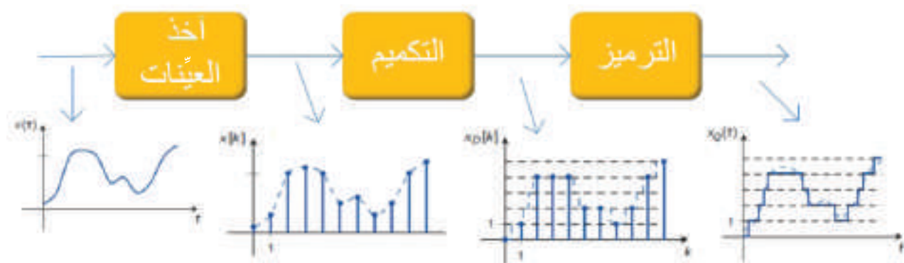
الشكل (8): تحويل الإشارة التماثلية إلى إشارة رقمية.
