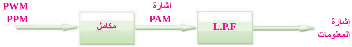
الشكل (19): كشف إشارة تضمين عرض النبضة (PWM)، وموقع النبضة (PPM).
