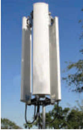
الشكل (43): الهوائي القطاعي.
