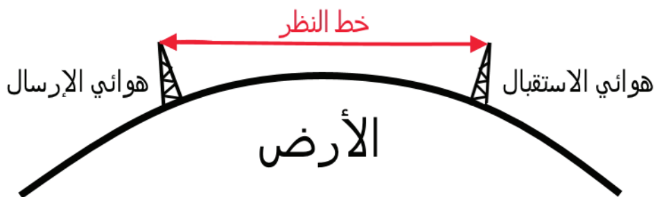
الشكل (3): انتقال موجات الميكروويف على طول خط النظر.
