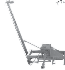
الشكل (١-١٩): المحشة الترددية.
