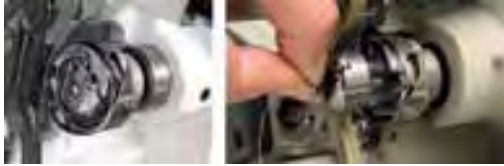
الشكل (٢-٤٢): حافظة المَكوك في آلة الدرزة الصناعية.
