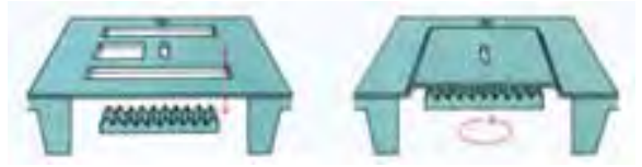
الشكل (٢-٢٧): إلغاء حركة مشط التغذية.
