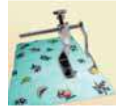
الشكل (٣-٣٦): القدم الضاغطة الخاصة بضبط المسافات.
