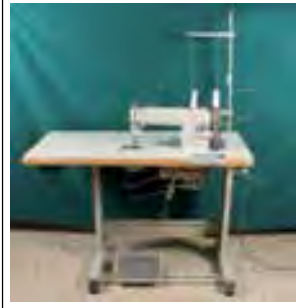
١- حامل البكرات ٢- مفتاح التشغيل ٣- رافع القدم ٤- المحرك ٥- الدعسة ٦- القشاط
