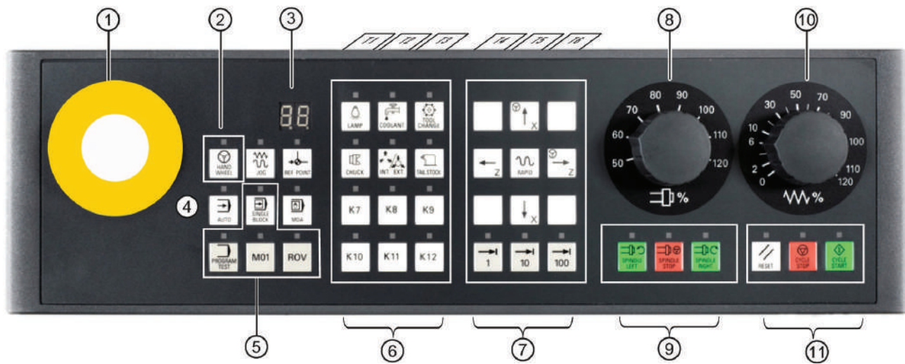
الشكل (9): المفاتيح السفلية للوحة التحكم على ماكينة الخراطة المحوسبة.
