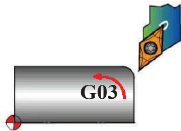
الشكل (16): الكود (G03) تشكيل قوس دائري عكس عقارب الساعة.
