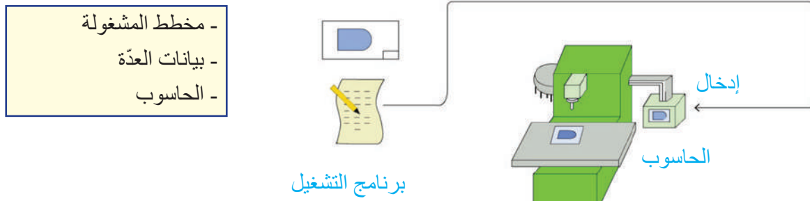
الشكل (2): الأجزاء الرئيسية لنظام التحكم الرقمي (CNC)
