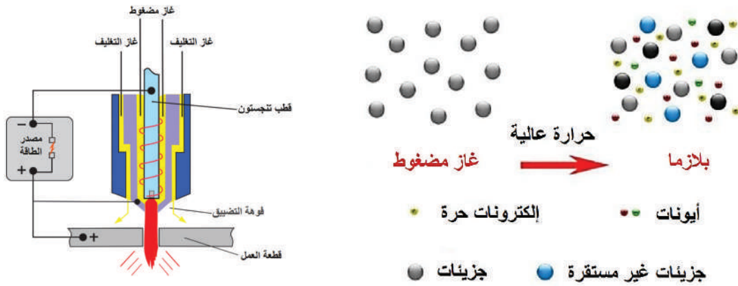
الشكل (1): مبدأ عمل القطع بالبلازما.
