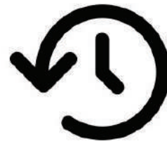
الشكل (16): الكود (G03) تشكيل قوس دائري عكس عقارب الساعة.
