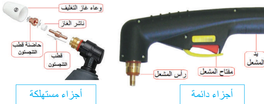
الشكل (5): أجزاء مشعل قطع البلازما.
