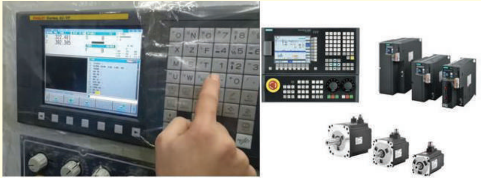
الشكل (15): نظام التحكم (SINUMERIK) و(Fanuc).
