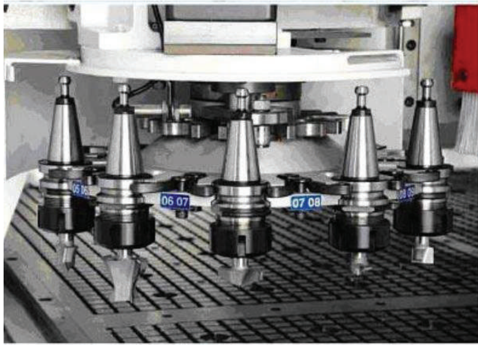
الشكل (12): مخزن أدوات القطع (برج أداة القطع).
