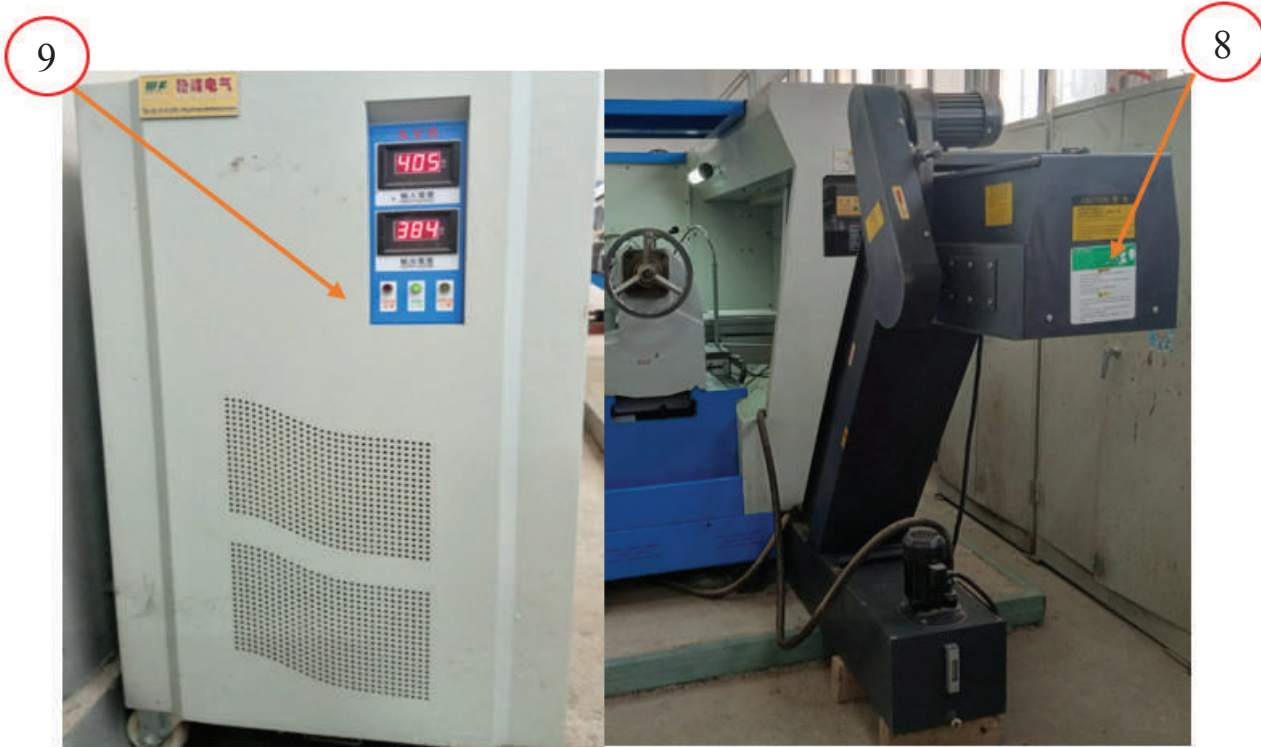
الشكل (7): جهاز فرق الجهد وقشاط خروج الرائش.
