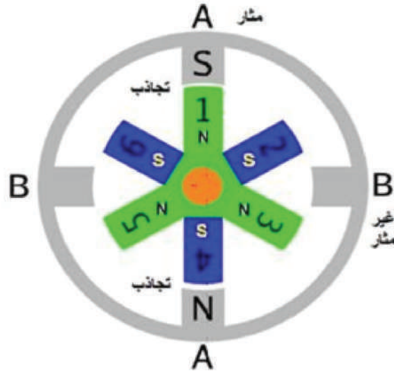
الشكل (3-42): محرك الخطوة ذو المغناطيس الدائم.
