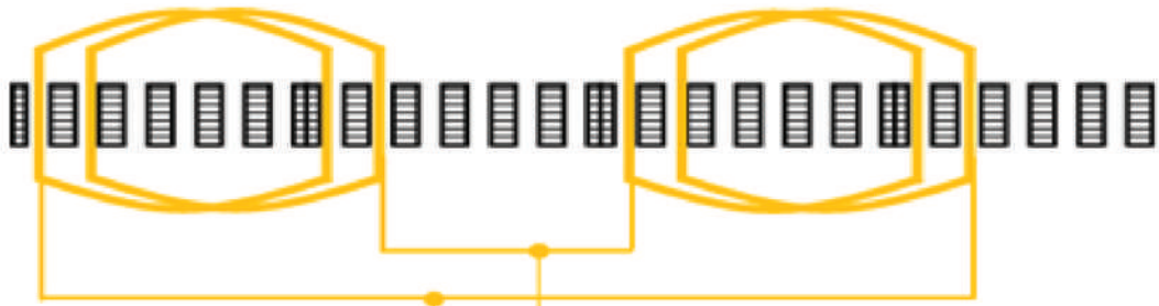
الشكل (1-48/ب): التوصيل على التوازي (سرعة عليا).
